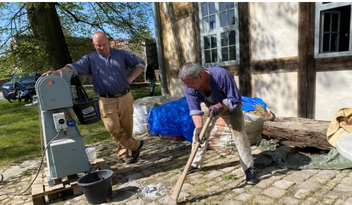
Abbildungsbeschriftung: Aufbereitung Wolfgang Maaßen Arbeit am Backenbrecher Foto M. Oberliesen
