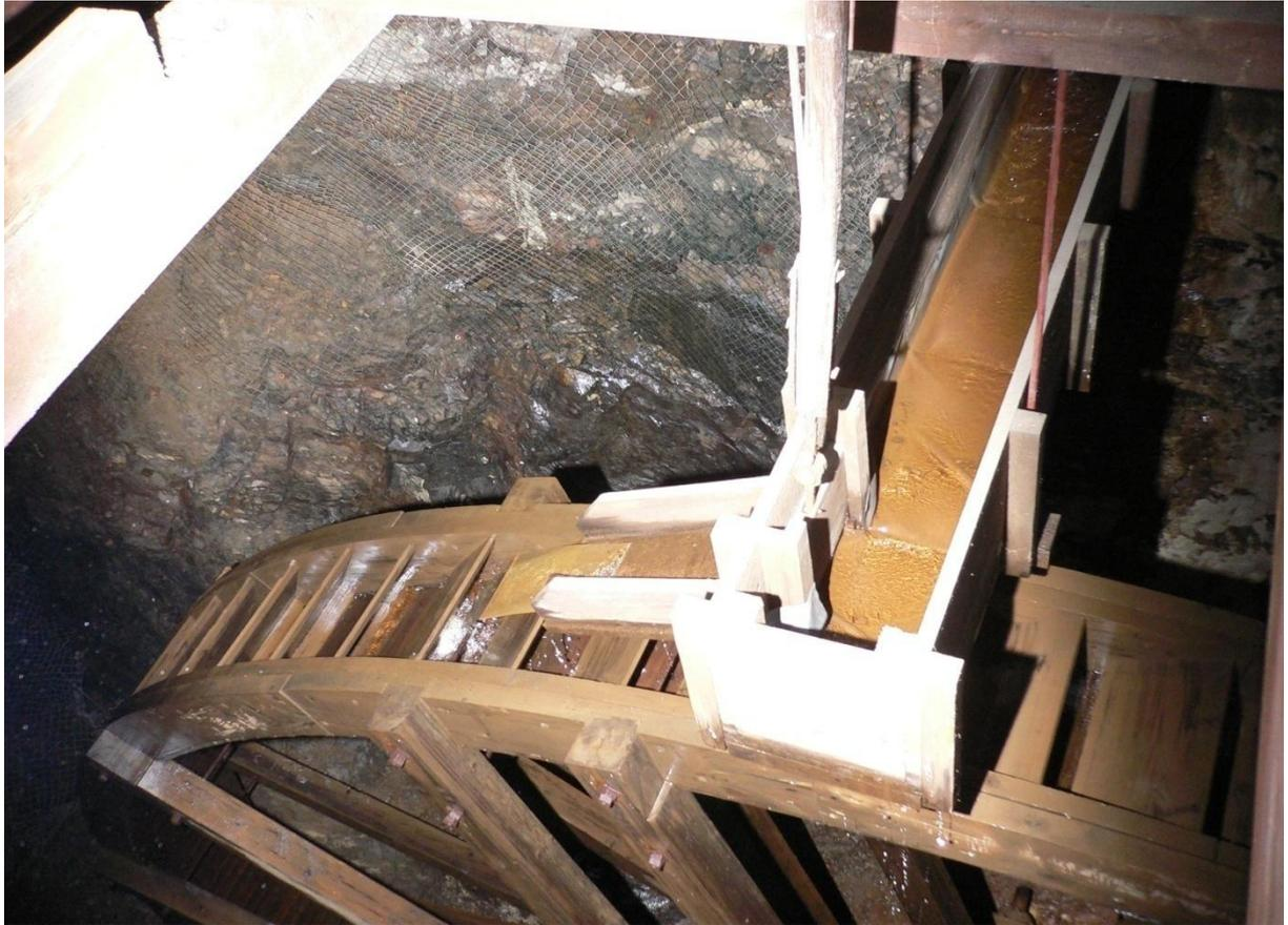
Über diesen Wasserkasten mit Schütz konnte die Zulaufmenge geregelt werden
