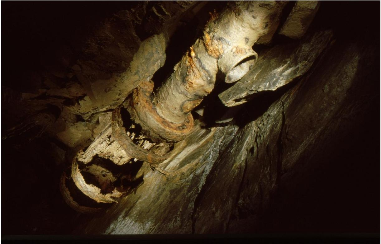
Steigrohr zur Führung der Kolbenstange mit Auslaufstutzen (Metall)
