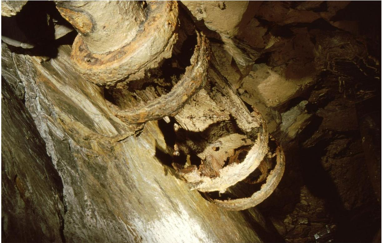
Das Steigrohr ist im Pumpenkörper eingelassen und befestigt (Pfeil)
